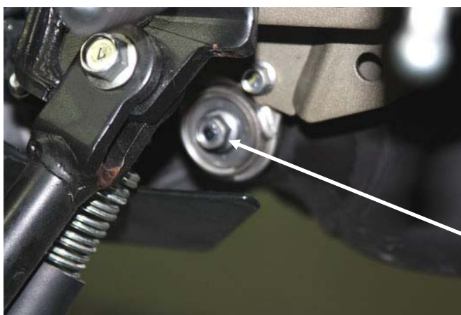
Dopo aver svitato le flangie rimuovere tutto il blocco del terminale originale attraverso le 2 viti Unscrew the screws shown above and remove the whole exhaust system
