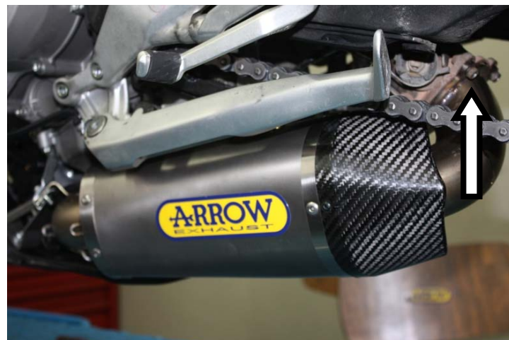
Innestare il terminale SX nel raccordo e serrare la flangia al raggruppamento utilizzando guarnizione e viti originali Fit LH silencer to the link pipe and secure it to the OE pipes using OE hardware
