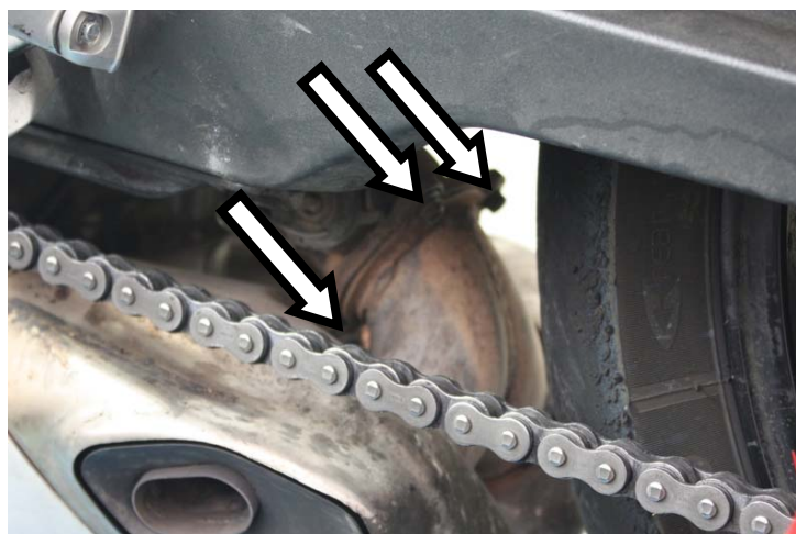
Svitare le viti (3) dalla flangia dello scarico Unscrew the 3 screws holding OE silencers to OE pipes
