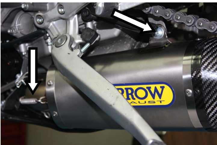
Serrare il terminale alla bielletta mediante viti TCEI M8x20mm, rondelle e dado autobloccante. Ancorare la molla col raccordo Secure the silencer to the mounting plate using socket head cap screws M8x20mm, washers and self-locking nuts. Secure the silencer to the link pipe using the spring
