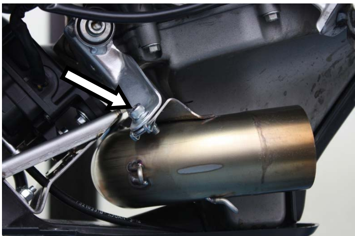
Fissare gli attacchi del raccordo (2) alla staffa anteriore di sostegno terminale originale mediante viti M6x12mm e rondelle Secure the link pipes as shown above to OE front mounting bracket using socket head cap screws M6x12mm and washers
