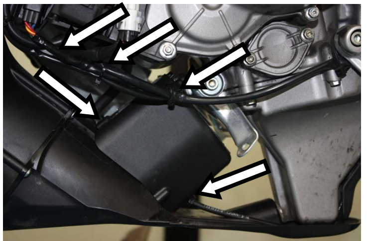
Tagliare le fascette a strappo di tutti i cablaggi posti in prossimità del coperchio motore attuatore valvola Cut and remove all the straps securing the exhaust valve cables near the cover of the actuator engine
