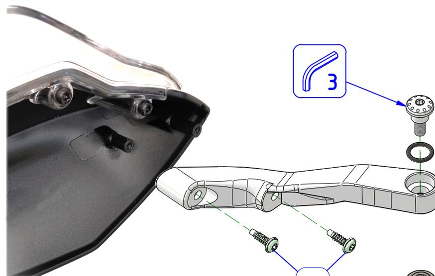
Sostituisce la vite OEM della pompa.
