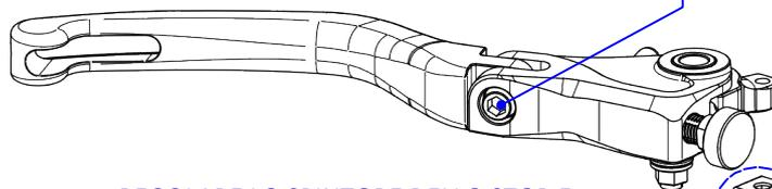
REGOLARE LO SPINTORE DELLO STOP E SERRARE LA VITE CON FRENAFILETTI MEDIO
