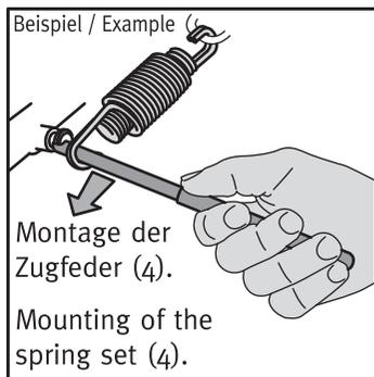
**INFORMATION** Zugfeder-Montagewerkzeug (WFF.00.138.100) separat erhältlich.
