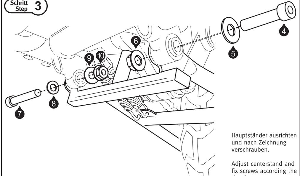
Hauptständer ausrichten und nach Zeichnung verschrauben.
