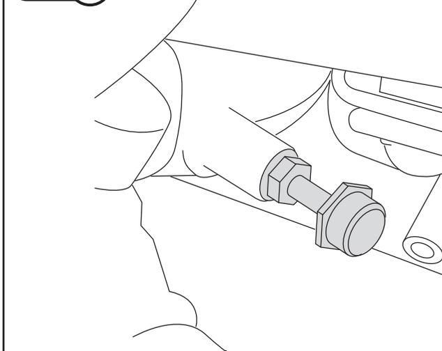
Bitte stellen Sie durch Justierung der Endposition des Seitenständers mit Hilfe der Seitenständers-Anschlagschraube sicher, dass ausreichend Platz zwischen Haupt- und Seitenständer ist.
