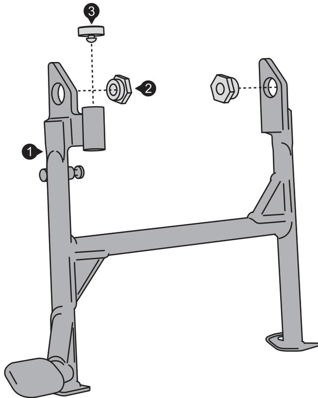
**ACHTUNG:** Setzen Sie die Gelenkbuchsen (2) mit Schmierfett in die Befestigungslaschen des Hauptständers (1) ein.
