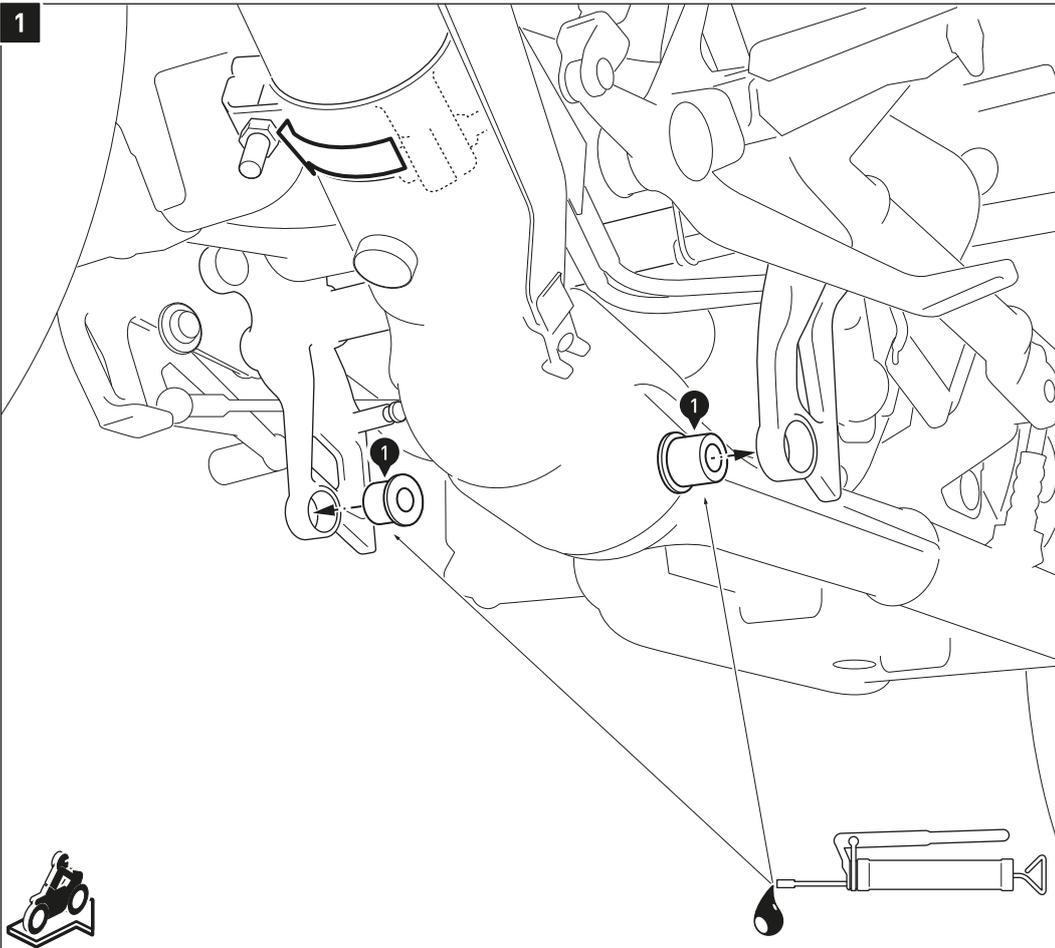
**ACHTUNG:** Lösen Sie die Schraube der gezeigten Auspuffschelle und drehen Sie diese um 45° nach links, da sonst der Hauptständer im hochgeklappten Zustand anschlagen kann!
