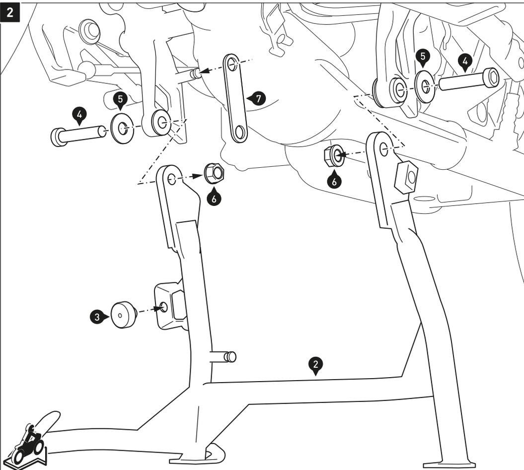
Setzen Sie den Gummidämpfer (3) in die Öffnung des Hauptständers (2) ein.
