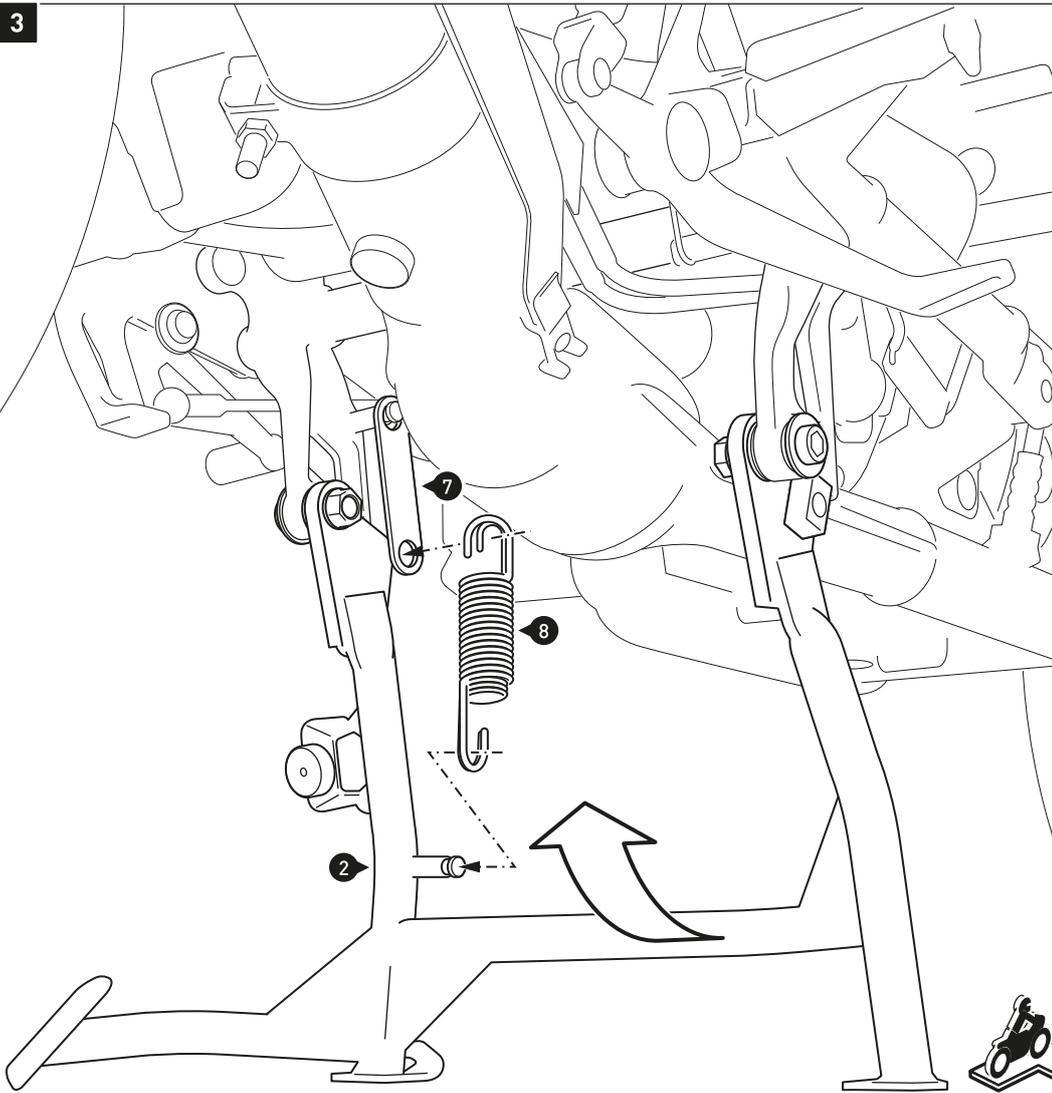
Hängen Sie den Zugfedersatz (8) an das Federanlenkblech (7).
