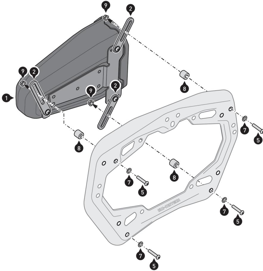
**Montaggio sul telaio laterale PRO - punti di fissaggio esterni senza perni di guida TRAX**
