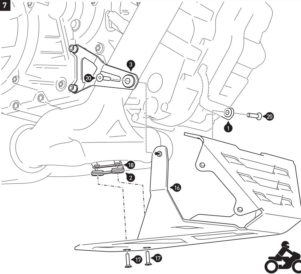
**⚠ HINWEIS:** Verschrauben Sie das Unterteil (16) locker mit den Schrauben (20) an den Anbaublechen (1) und (3), um die Montage zu erleichtern.
