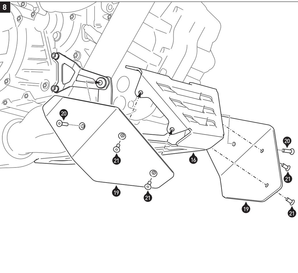
Verschrauben Sie die Verkleidungsteile (19) mit dem Unterteil (16).
