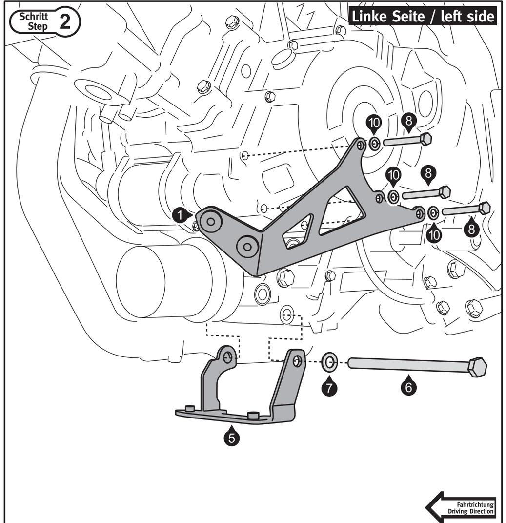
Demontieren Sie, falls vorhanden, den originalen Kunststoffmotorschutz. Entfernen Sie die originalen Schrauben von den gezeigten Anbaupunkten. Verschrauben Sie anschließend die Anbaubleche (1) und (5) auf der linken Fahrzeugseite wie gezeigt. Sichern Sie alle Gewinde mit flüssiger Schraubensicherung. Ziehen Sie die Schrauben (6) und (8) noch nicht an.
