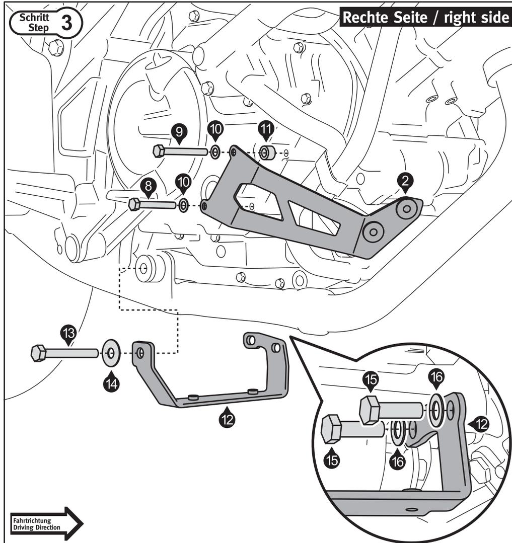
Entfernen Sie die originalen Schrauben von den gezeigten Anbaupunkten. Verschrauben Sie anschließend die Anbaubleche (2) und (12) auf der rechten Fahrzeugseite wie gezeigt. Das Anbaublech (12) muss auf der rechten Fahrzeugseite hinter der Seitenständeraufnahme verschraubt werden, wie im Detailbild gezeigt. Sichern Sie alle Gewinde mit flüssiger Schraubensicherung. Ziehen Sie die Schrauben (8) und (9) noch nicht an.
