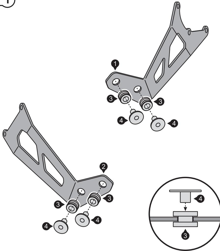
Setzen Sie die Gummitüllen (3) und die Bundbuchsen (4) in die gezeigten Öffnungen der Anbaubleche (1) und (2) ein.
