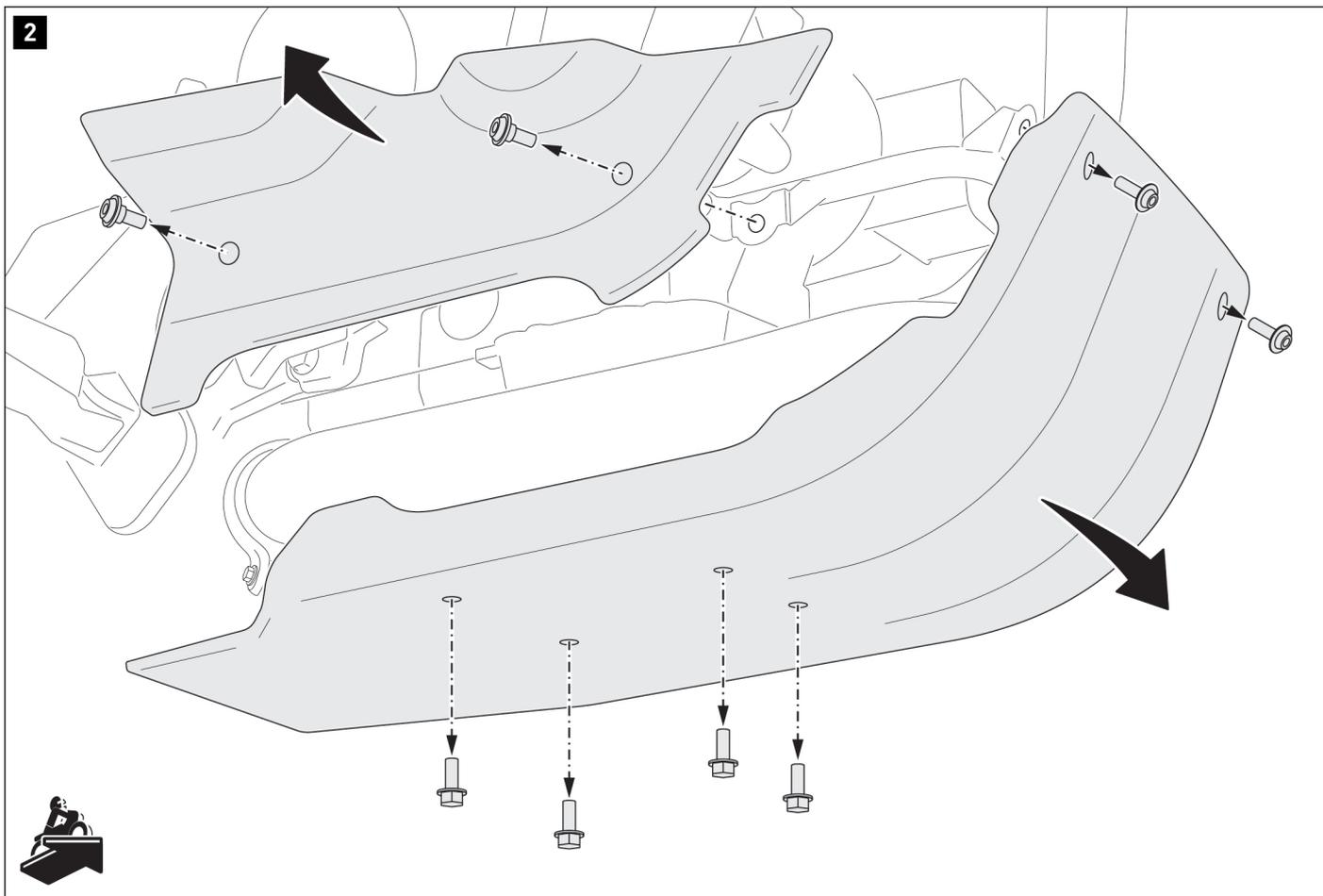
Rimuovere dal veicolo la protezione originale del motore e il pannello di rivestimento destro.
