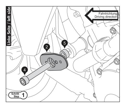
**Achtung:** Montieren Sie das Sturzpad erst auf der linken Seite, dann auf der rechten Seite. Entfernen Sie die original Motorhalteschrauben keinesfalls auf beiden Seiten gleichzeitig.
