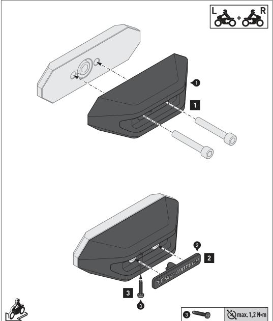
Schritt [1]: Verschrauben Sie die Sturzpads (1) beidseitig an den Adapterplatten Ihres SW-MOTECH Sturzpad-Kit, wie in der Anleitung des Sturzpad-Kit beschrieben.
