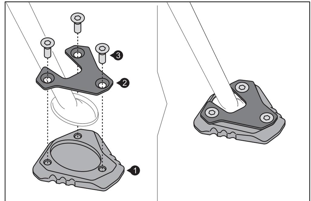
Sichern Sie alle Gewinde mit flüssiger Schraubensicherung, um ein Lösen der Anbauteile durch Vibrationen zu vermeiden!
